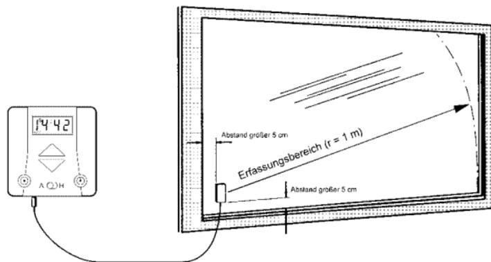
Für die Zusatzfunktion „Glasbruchmelder“ wird zu jeder Rolladensteuerung **Vestamatic® Rolltec Plus G/S 500** ein (bei größeren oder geteilten Scheiben mehrere) Glasbruchmelder benötigt. Im nachfolgenden Text wird beschrieben, wie die Installation durchgeführt wird.
