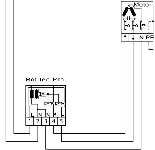
Die Klemmenbelegung der Rolltec Pro entspricht der Klemmenbelegung der Rolltec Pico
