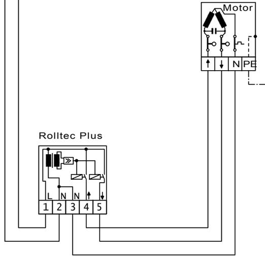
Die Klemmenbelegung der Rolltec Plus entspricht der Klemmenbelegung des VestaLogo
